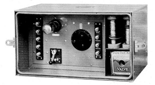
MARCONI R.'P. II TIME-SIGNAL RECEIVER. Phasing Unit. Récepteur Marconi R. P. II pour Signaux Horaires Ensemble de phasage.
