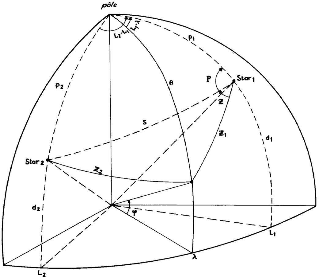
FIG. 1. — Triangles sphériques servant au calcul numérique du point.
