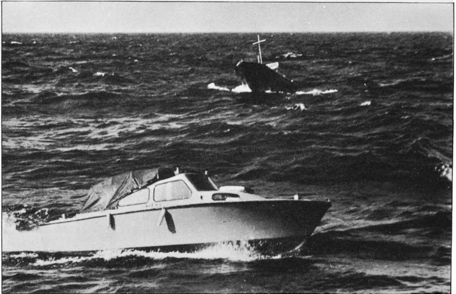
FIG. 3. — Embarcation rapide pour sondages parallèles. Celle-ci a une coque en plastique renforcée de fibres de verre et un élément de propulsion Penta Aquamatic à l'intérieur et hors-bord. Le transducer du sondeur à écho est monté sur le côté de l'embarcation.
