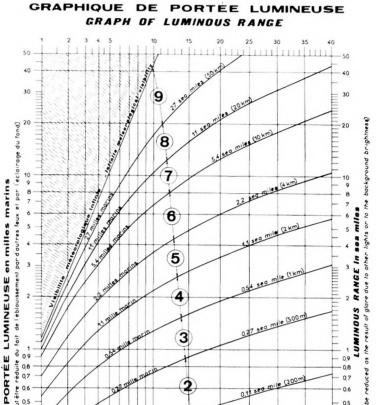
INTENSITÉ LUMINEUSE<sup>(1)</sup> en candelas -LUMINOUS INTENSITY<sup>(1)</sup> in candelas (1) Pour les feux à éclats brefs, l'intensité lumineuse à prendre en comple est celle qui résulte de la formule de BLONDEL-REY (ormula be considered is that derived from the BLONDEL-REY formula
