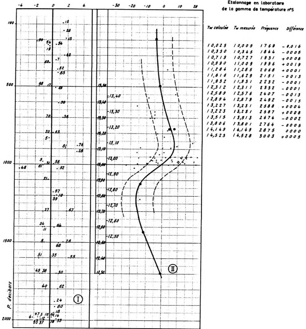
Etalonnage en température de la sonde n°731
