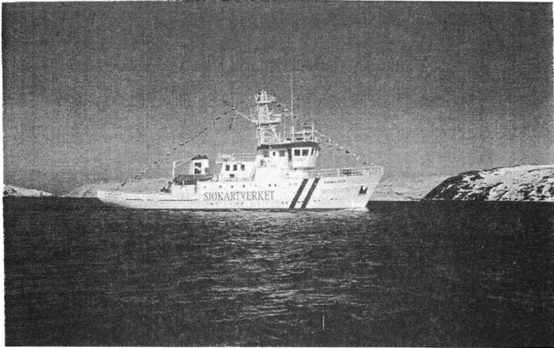
FIG. 2.- SJØMÅLEREN 300 ton coastal multibeam survey vessel.
