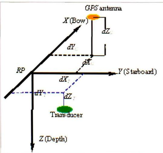
Figure 7: Vessel frame system (VFS).
