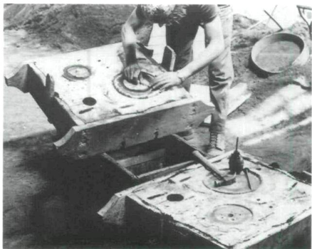
Fig. 6. L'enlèvement des modèles de bois de la partie supérieure du moule de sable.
